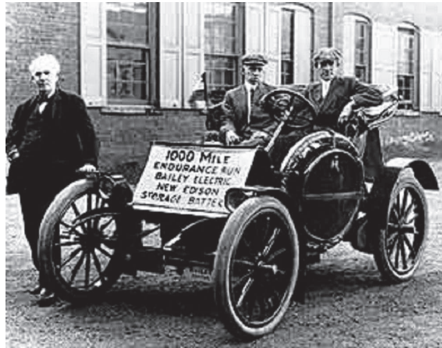
La Bailey Electric par des accumulateurs NICKEL FER
