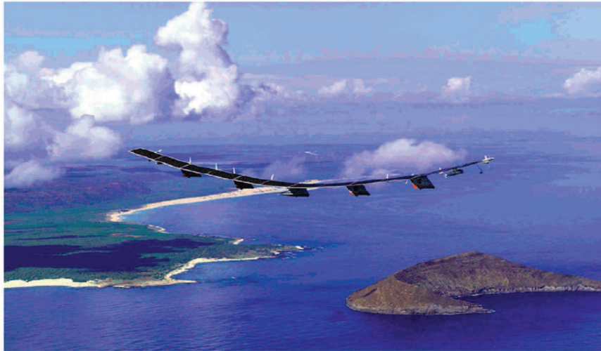
Helios HP03 en vol. les réservoirs des piles à combustible en bout d'ailerons.
